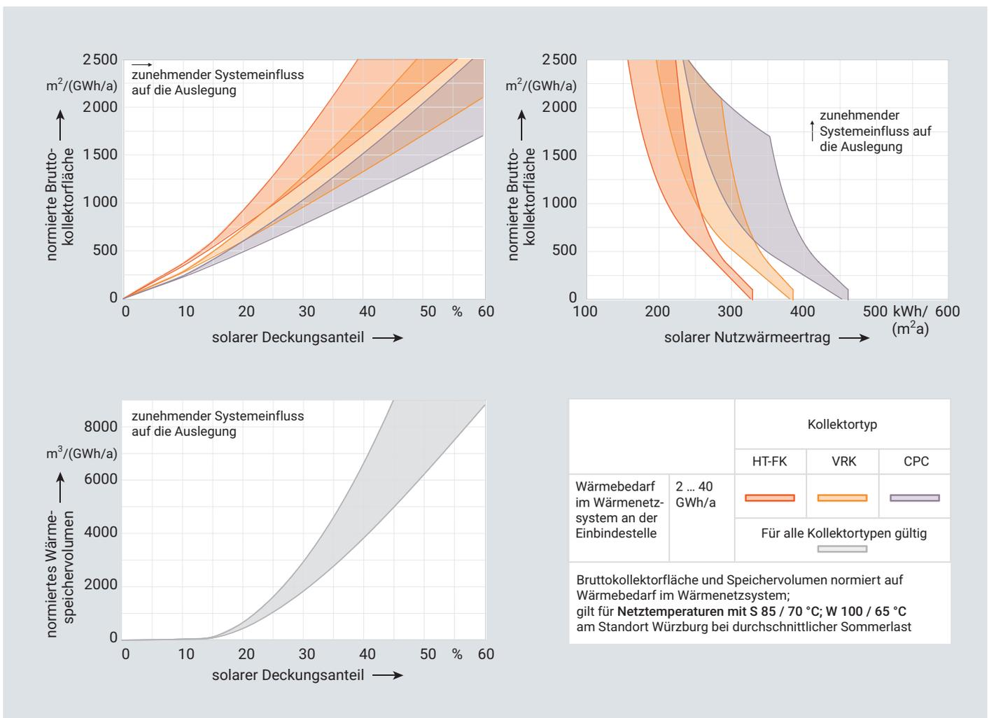
Bild 3. Nomogramme für hohe Betriebstemperaturen des Wärmenetzes (Vorlauftemperaturen zwischen 85 °C und 100 °C)
